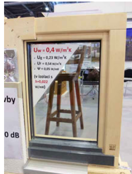
Okno vhodné pro neosluněné strany s U_w = 0,4 \text{ W/m}^2\text{K} zasklené izolačním trojsklem s jednou meziskelní folií s U_g = 0,25 \text{ W/m}^2\text{K} a prostupem světla LT = 63 \%
