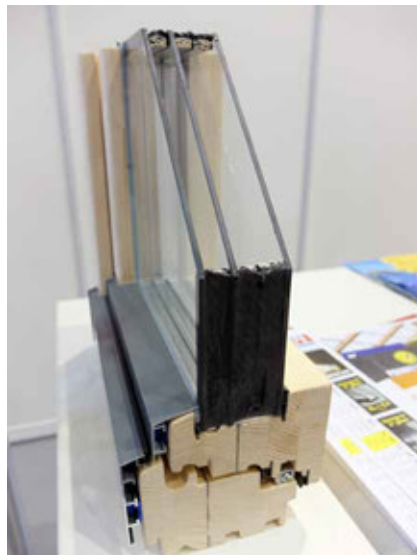
Okno vhodné pro neosluněné strany s U_w = 0,4 \text{ W/m}^2\text{K} zasklené izolačním trojsklem s jednou meziskelní folií s U_g = 0,25 \text{ W/m}^2\text{K} a prostupem světla LT = 63 \%
