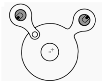
Znázornění funkce mechanismu: Křížek představuje ideální osu nástroje a její vychýlení z naprogramované dráhy, kroužek ukazuje skutečnou polohu frézy
