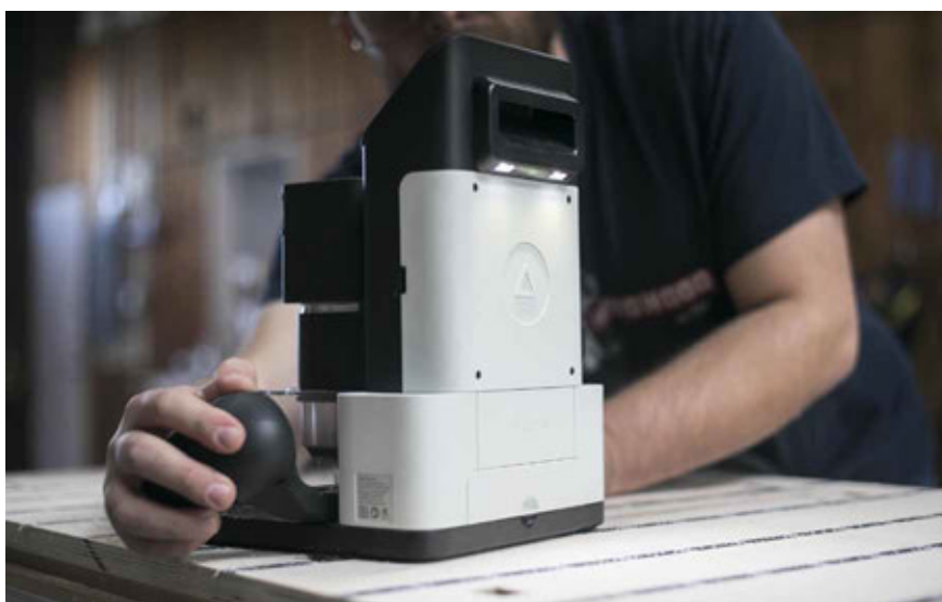
Na přední straně řídicí jednotky je umístěna snímávací kamera s LED osvětlením
