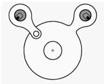
Schematicky znázorněný princip mechanismu pro vyrovnávání nepřesných pohybů při ručním vedení frézky
