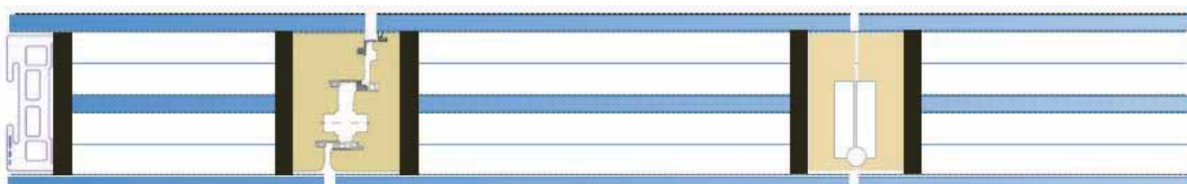
Fasádní systém s rámovými profily integrovanými přímo do izolačního trojskla
